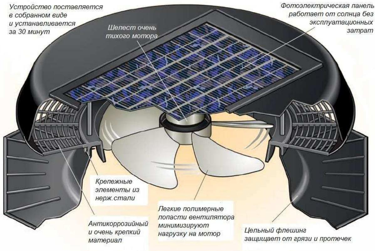
Номинальный объем воздуха, перемещаемого вентилятором Solar Star®, составляет до **30м<sup>3</sup>/мин** и зависит от интенсивности солнечного освещения.
